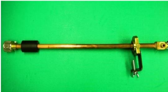
吸上センサー「NEP-SPS」は、チップ潤滑装置のペール缶に取付けられる弊社製潤滑剤吸上パイプに新開発超小型の磁気近接スイッチを内蔵させ、ペール缶内の液残量を検知することを可能とさせるシステムで、吸上センサーとパトライトを具備した制御ボックスより成り立ちます。
