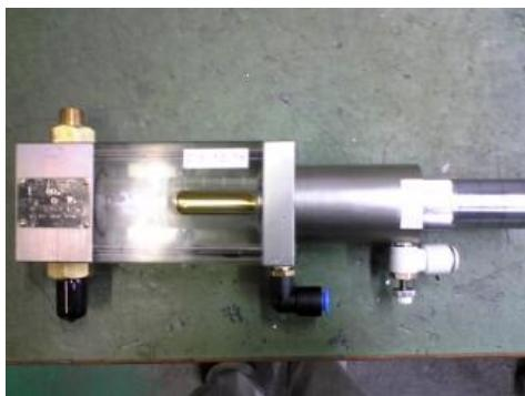
2S-002型潤滑ポンプは、プランジャーーチップへの潤滑剤供給をより正確、確実におこなうことができるよう開発された潤滑ポンプです。当社製2S型潤滑ポンプに対し、プランジャーーピストンの動作と高圧側ピストンOリングの交換時期を外部から目視確認ができるように変更し、スケルトンボディにすることでポンプ内の潤滑剤充填量も確認する事が出来るようになりました。これにより潤滑剤の吸入・吐出・ピストン速度のより細かな管理が可能となりました。
